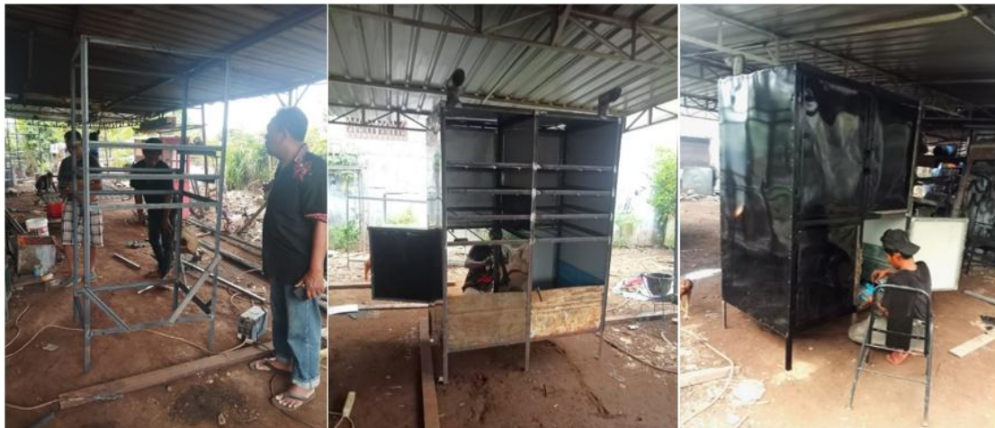
Gambar 5. Rancang Bangun Lemari Besi Pengasapan Ikan
