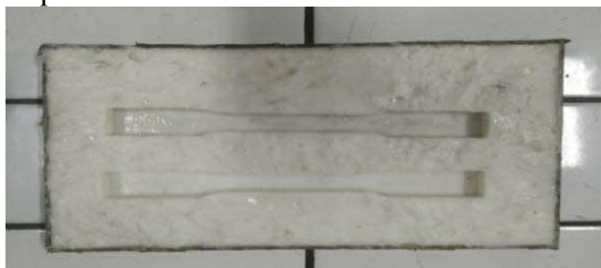
Gambar 4. Cetakan specimen dari bahan silica rubber
