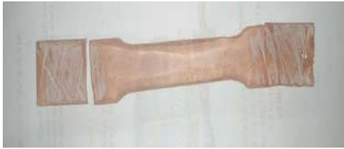
Gambar 5. Tampak patahan spesimen uji tarik tanpa serat
