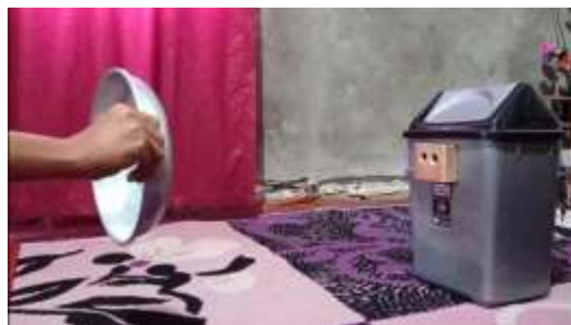
Gambar 5. Pengujian Tempat Sampah Otomatis dengan Besi
