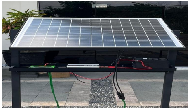
Gambar 4. Metode Pendinginan Konveksi Bebas (Udara).
