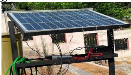
Gambar 4. Metode Pendinginan Konveksi Paksa (Pompa Air)
