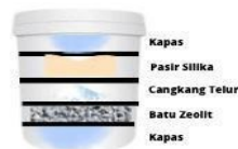
Gambar 1. Ilustrasi Skema Filter Air menggunakan ember cat
