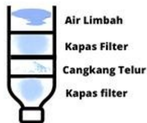
Gambar 2. Ilustrasi Skema Filter Air menggunakan Botol plastik
