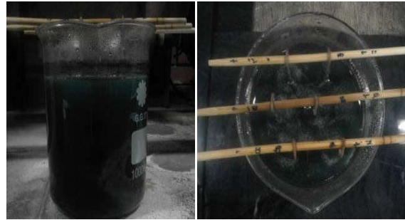
Gambar 5. Pencelupan Spesimen ke dalam larutan asam sulfat
