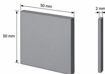
Gambar 4. Dimensi Spesimen Baja ASTM A36
