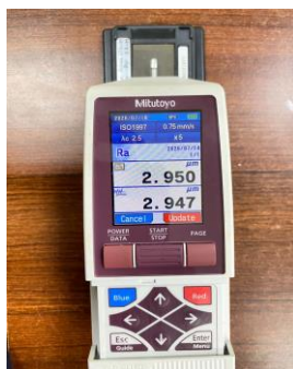
Gambar 5. Alat Uji Kekasaran Permukaan Mitutoyo SurfTest SJ-210
