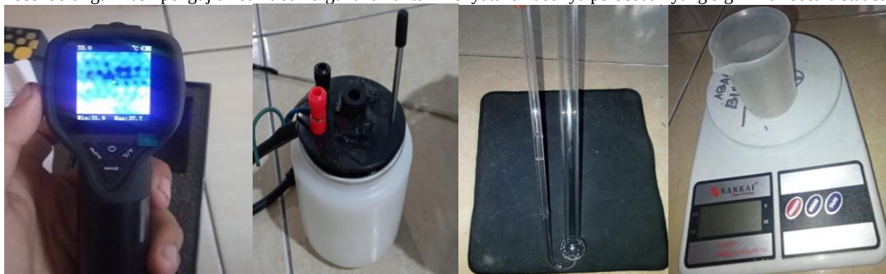
Gambar 5 (a). Kamera Termal (b). Joule Calorimeter, (c). Gelas Ukur, (d). Viskometer Ostwald
