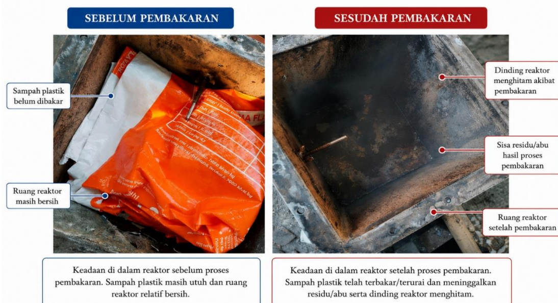
Gambar 3. Pengujian Material PP.
