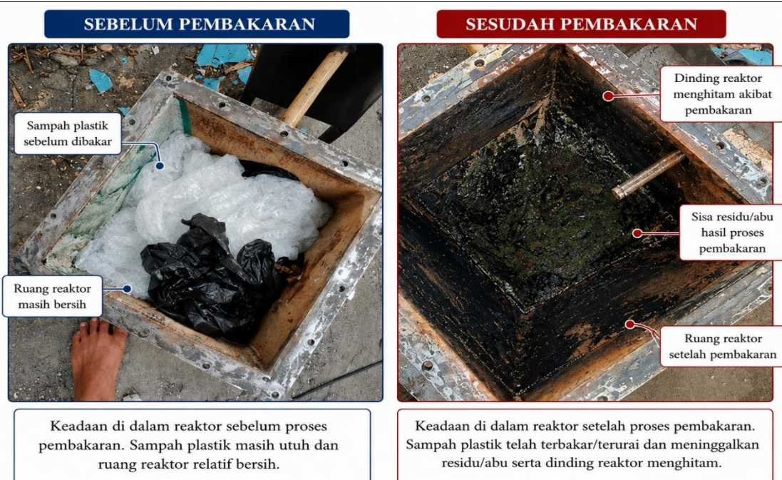
Gambar 4. Pengujian Material LDPE.
