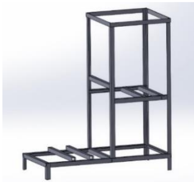
Gambar 1. Geometri struktur rangka mesin briket arang
